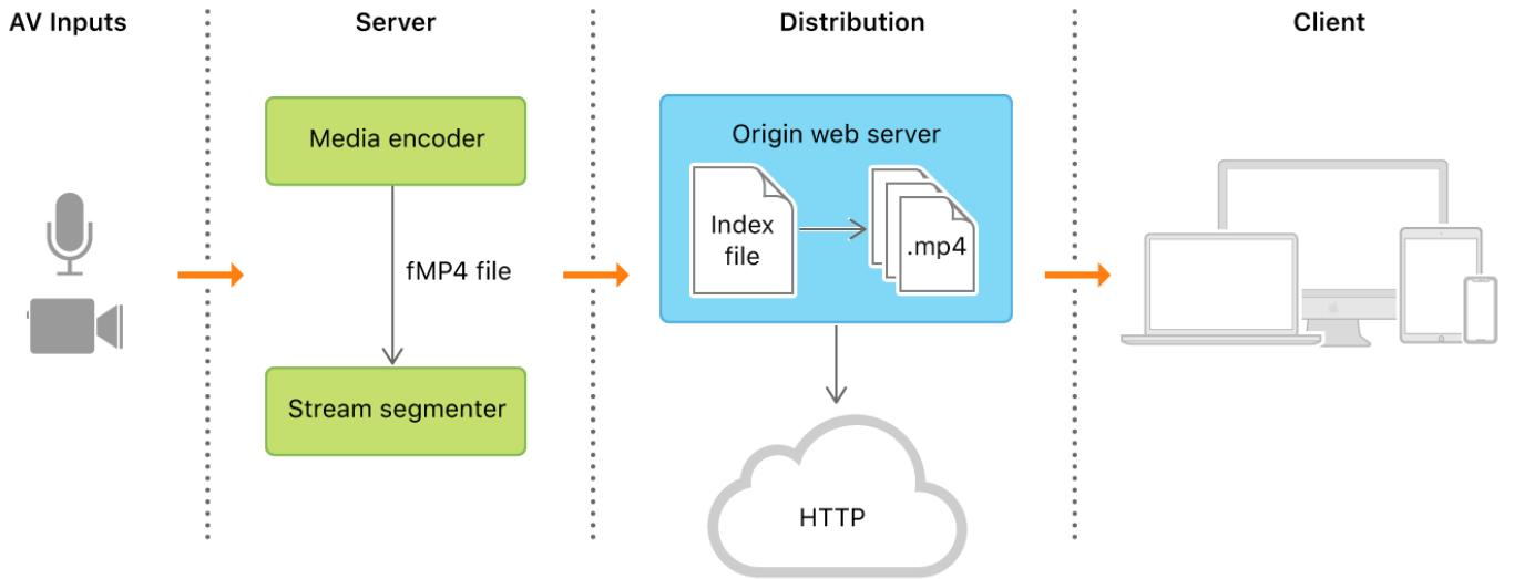
Client 端在播放的時候，首先抓取 `.m3u8` 檔案，檢查當中有哪些 `ts` 檔案，在直播的狀況下，可能在 `.m3u8` 檔案中，就留了最新的三個 `ts` 檔，client 端就從第一個 `ts` 檔案開始輪流抓取、播放，在快要把這三個 `ts` 檔都快要播完的時候，就再去檢查一次 `.m3u8` 檔案，查看是不是還有更新的 `ts` 檔案，如果有，就繼續抓取這些新的 `ts` 檔。這個步驟就不斷的輪迴，直到發現沒有更新的 `ts` 檔案，代表直播已經結束。
