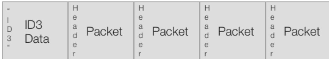
ID3 metadata 也是一連串的 **binary data**，目前比較通行的是第二版的 ID3v2，會出現在整個 MP3 檔案最前面的位置。ID3 資料的前三個 bytes 就是 "ID3" 這三個字元的 ASCII code。在讀取 MP3 檔案的時候，只要一開始就讀到這三個字，就可以判斷這個檔案有 ID3 資訊；接著，我們就來處理正段資料的前 10 個 bytes，在這 10 個 bytes 中，除了 "ID3" 這三個字之外，還包含了這是那個版本的 ID3，以及整段 ID3 資料區段的長度有多少等資訊...我們就一直讀到這個長度範圍。
