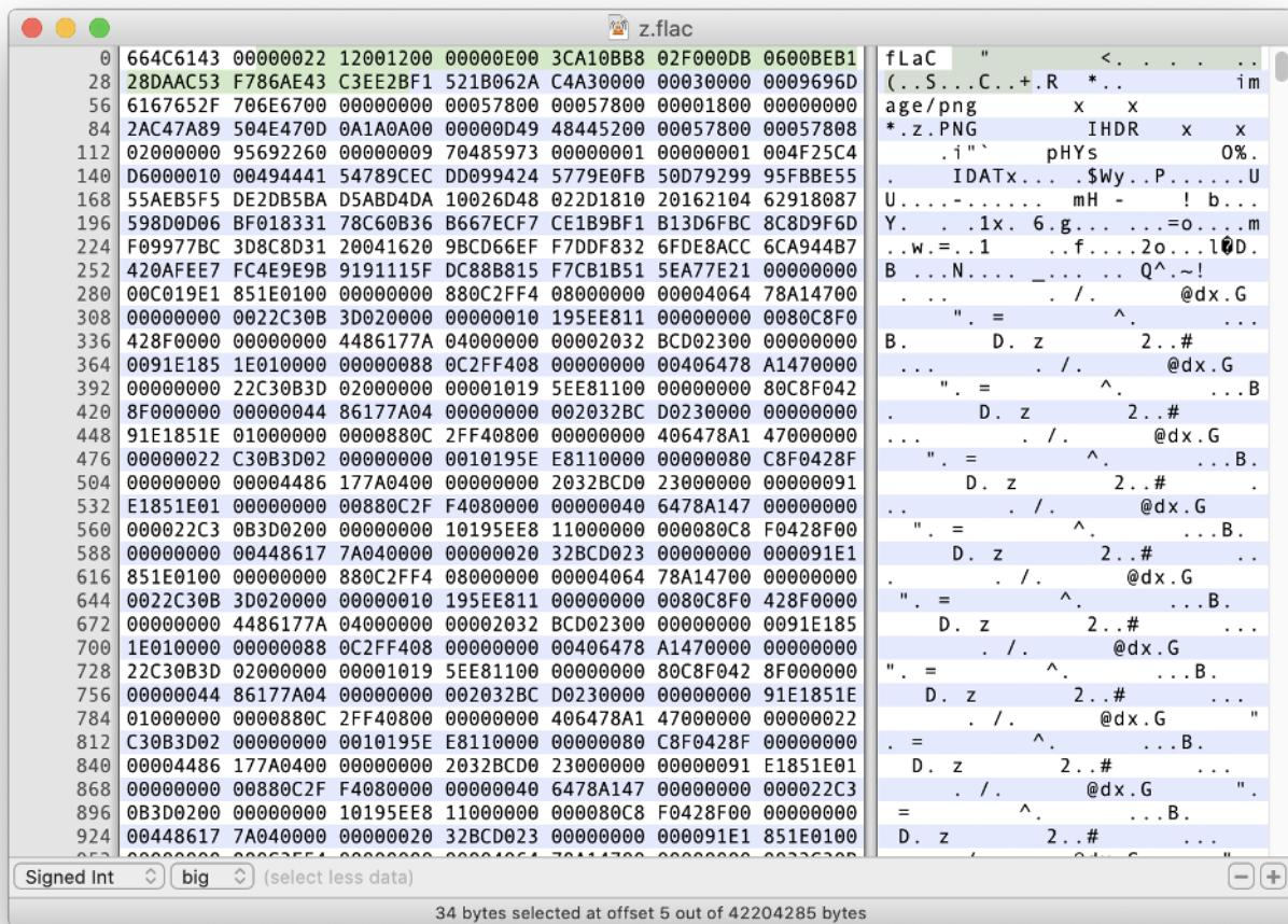
我們可以看到，檔案開始的前 4 個 bytes，就是 "fLaC" 四個字，第五個 byte 為 0：第一個 bit 是 0，代表後面還有其他的 metadata block，另外 7 個 bits 也是 0，代表這段是 stream info，然後就是 34 個 bytes 的 stream info 的內容（圖片中被選取起來的地方）—不過，我們就得要讀出每個 bits，才能了解當中的意義了。至於 stream info 之後，是第二個 metadata block，我們可以判斷出，這邊放了一張封面圖片。
